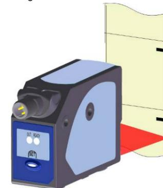
Die HELL-/DUNKEL-Schaltung wählt der Sensor automatisch an. Dunkle Markierung-heller Hintergrund ->Dunkelmodus; helle Markierung-dunkler Hintergrund ->Hellmodus.
