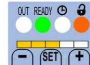
Durch Inkrementieren oder Dekrementieren des Schwellenwerts blinken das rechte oder das linke LED in einer Frequenz auf, die proportional zur Abweichung vom Schwellenausgangswert steht.
