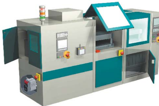
Abb. 4 Kontrolle von Öffnungen über Sicherheitsfotозellen
