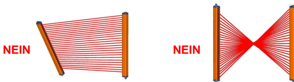
Abb. 17- Falsche TX-RX Ausrichtung des Lichtvorhangs
