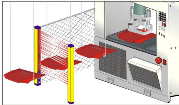
Der Zweck seines Einsatzes liegt darin, dem Einquetschen der Bedienerhände während des Aufstapelverfahrens des gefertigten Produkts vorzubeugen. Die zum Einsatz kommende Lösung darf sich darüber hinaus nicht auf den Produktionsprozess auswirken. Im Arbeitsumfeld liegen eine Feuchtigkeit von 85% und eine Temperatur von 25 °C vor: Es erfolgen häufig Wäschen mit alkali- oder säurehaltigen Reinigungsmitteln und zum Abspülen werden Kaltwasserstrahlen (5 - 10 °C) mit einem Druck von 40 bar verwendet.
