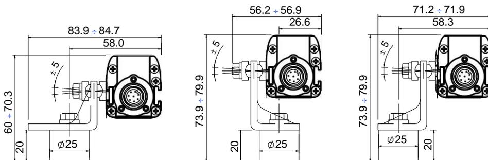
*Befestigungswinkel + verstellbare Halterung + schwingungsdämpfende Halterung*
