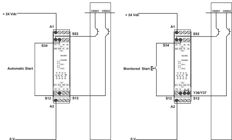
Auf den Abbildungen wird die Verbindung zwischen den Sicherheitslichtvorhängen und dem Sicherheitsrelais der SE-SR2 Serie im automatischen Start-Modus (links) und manuellen Start-Modus mit Überwachung (rechts) gezeigt.
